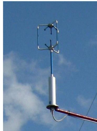
Abbildung 15: Ultraschallanemometer
