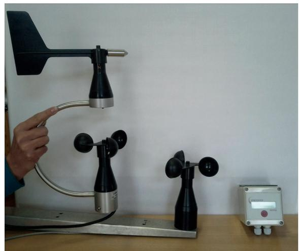
Abbildung 17: Kombi Anemometer mit Windrichtungsgeber - Schalenkreuzanemometer - Datenlogger
