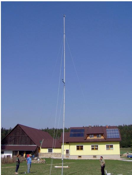
Abbildung 18: Professionelle Windmessungen mit geeigneten Messmasten
