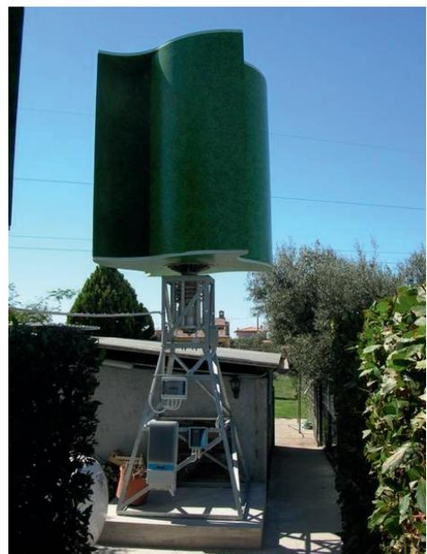
Abbildung 8: Savonius Rotor
